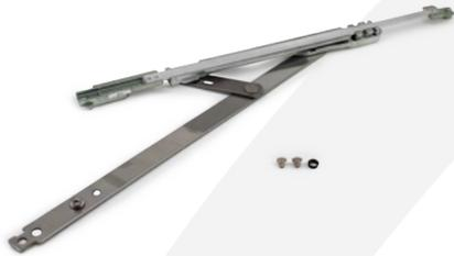
Compás grande para mecanismo oscilobatiente (para hojas de 526 mm hasta 1200 mm) con un cuerpo de zamak zincado y varilla deslizante de acero inoxidable además de un cilindro excéntrico de cierre de acero inoxidable con regulación transversal con tornillos de anclaje y de regulación.
