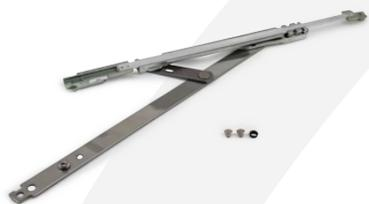
Compás grande para mecanismo oscilobatiente (para hojas de 526 mm hasta 1200 mm) con un cuerpo de zamak zincado y varilla deslizante de acero inoxidable además de un cilindro excéntrico de cierre de acero inoxidable con regulación transversal con tornillos de anclaje y de regulación.
