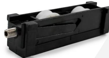
Rueda tándem fabricada en zamak, rodamientos de agujas y eje de acero inoxidable.
